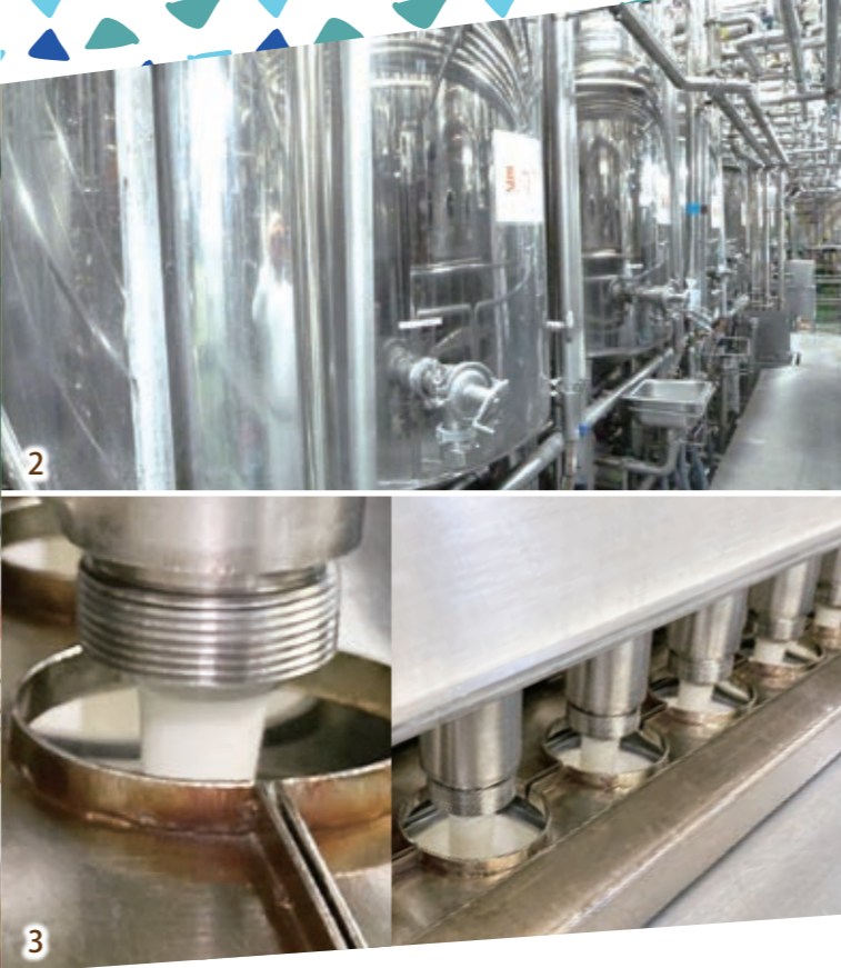
1.容器に充てんされ、完成。賞味期限の印字確認をして出荷される 2.乳酸菌が添加され、大きなタンクの中でゆっくりとヨーグルトに変わる 3.タンクからカップに充てん 4.この後、紙の台紙に6個ずつのせられ出荷へ 5.生乳ヨーグルトの容器にフタシールをする製造ライン 6.岡山県にある本社工場。牛乳やアイスクリームなどを製造
