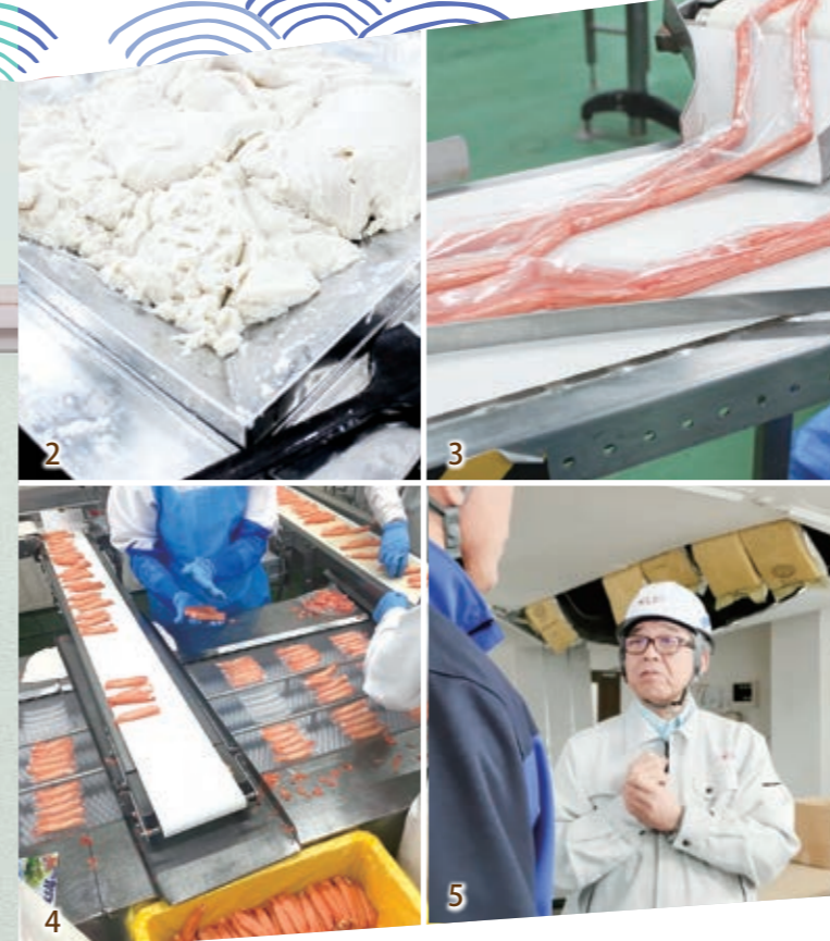
1.スギヨの社員の皆さん 製造、営業などの部署の社員 2.無リンすり身を使用し、ペースト状に 3.ペースト状にしたすり身をカニのむき身のように成型しトマトとパプリカの色素で着色 4.人の目でチェックしてパック 5.知事の視察に対応する杉野社長 6.北陸工場は天井が崩落した 7.カニカマを製造する商業団地工場では包装エリアの機材が倒れた 8.断水の続く中、地下水を住民に開放 9.ホワイトボードに書かれた言葉
